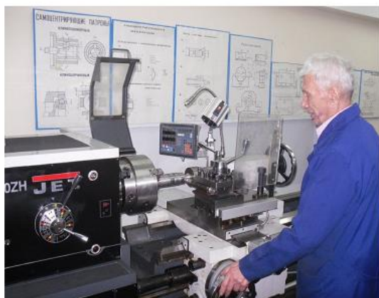
Рис. 1. Экспериментальный стенд на базе токарно-винторезного станка GH2060ZH
